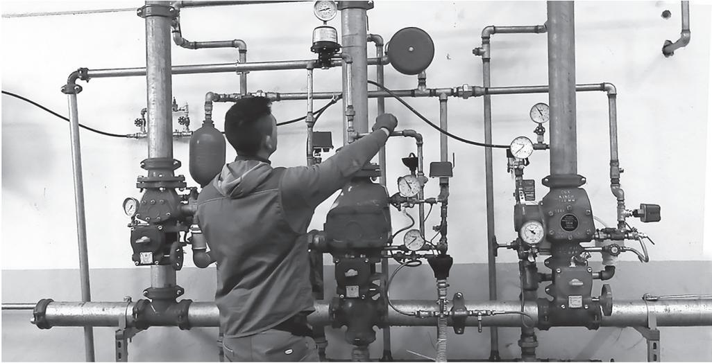
Figura 12.1 – Impianti sprinkler di prova utilizzati per la sperimentazione
